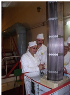
Проведення контрольних операцій з перевірки форми ТВЗ-WR
