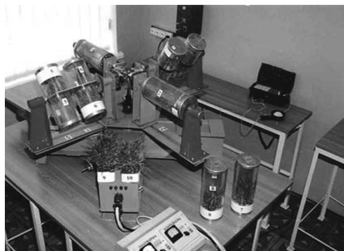
Выращивание вирус-инфицированных растений пшеницы на горизонтальном клиностате «Цикл-2» для исследования влияния моделированной микрогравитации на систему «вирус – растение – хозяин», руководитель д. биол. н. Л. Т. Мищенко (Киевский национальный университет им. Тараса Шевченко)
