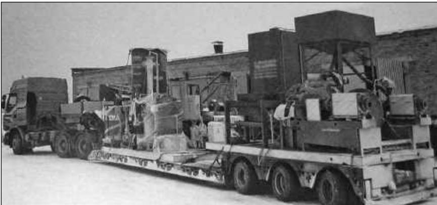
Автоматизований міні-завод для виробництва біопалива
